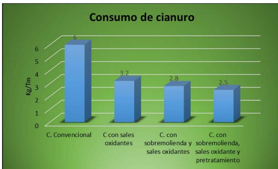
Figura 5. Consumo de cianuro de las pruebas metalurgicas.
