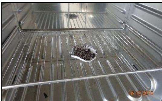
Figura 6. Muestra de lignina después del secado.
