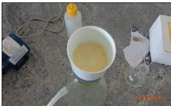
Figura 7. Muestra de celulosa después del filtrado al vacío.
