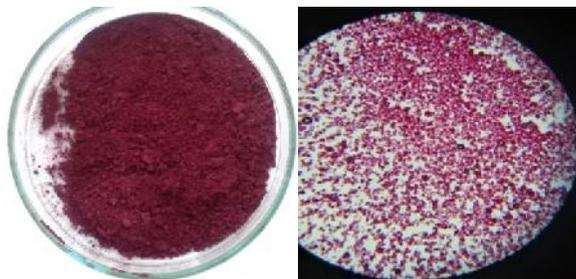
**Figura N°1** 1Fotografías del encapsulado de antocianinas de maíz morado. A la izquierda el polvo del encapsulado. A la derecha una fotografía con microscopio electrónico y amplificación de 20 X.
