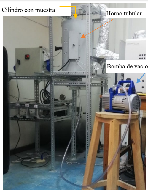
Figura 2. Sistema del reactor para el método TSA-VSA
