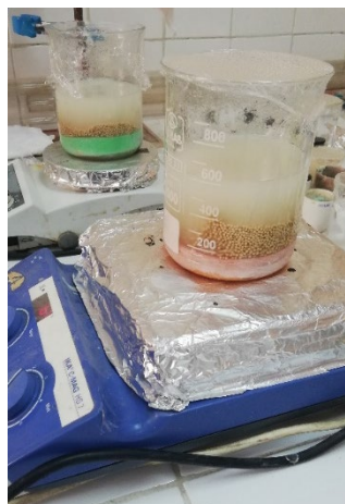
Figura 4. Sistema de intercambio iónico de zeolita
