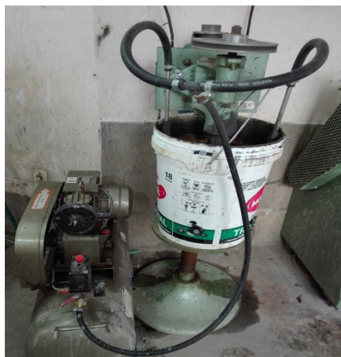
Figura 3. Equipo de cianuración por agitación de una capacidad de 18 litros 13
