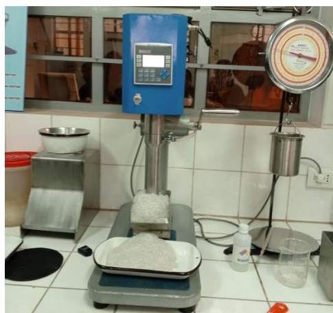
Figura 2. Flotación de mineral de litio
